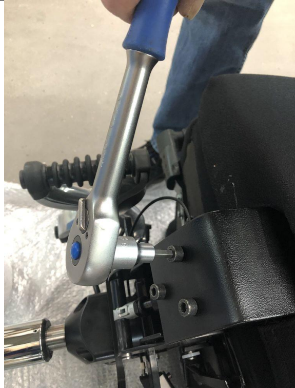
5. Mit einem Ratschen-Steckschlüssel Größe 6 die 3 Stück Inbus-Schrauben lösen und entfernen
