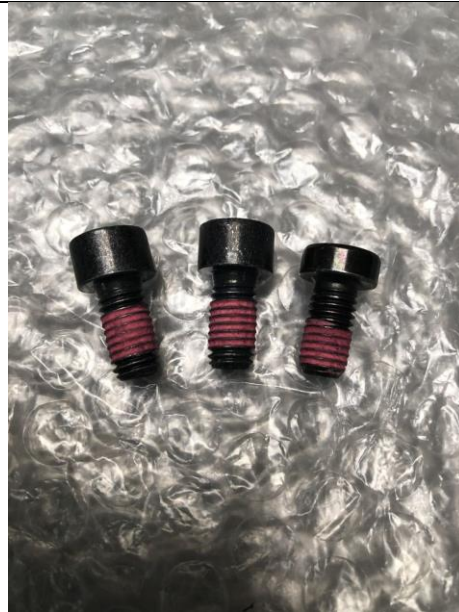
8. .. und bitte die NEUEN Inbus-Schrauben (mit rotem Tuflok beschichtet) einschrauben.
