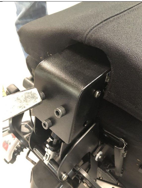
4. Mit einem Hammer kräftig auf die 3 Inbus-Schrauben der RL-Befestigung schlagen, damit sie sich besser lösen lassen.
