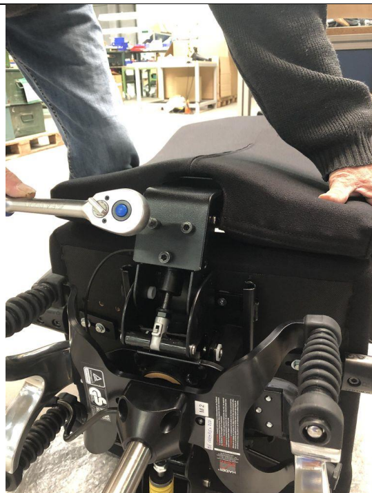
9. Danach die Rückenlehne mit einem Ratschen-Schlüssel (Inbus Größe 6) festschrauben.
